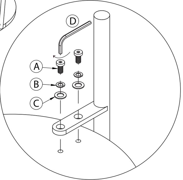
\* ボルトは最初8割程度の仮留めにしておき、全てのボルトが入ったことを確認してから最後に本締めをするとバランスよく組立てできます。
