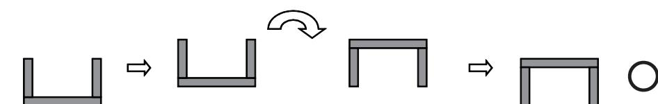
\* 完全に床から浮かせた状態で反転させて下さい。
