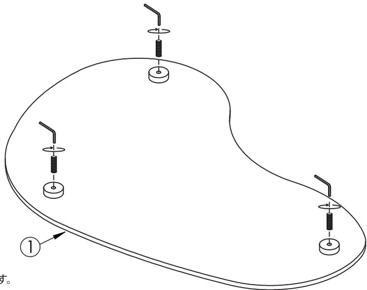
\* 部品Aを天板裏の脚受け穴に差込み、六角レンチBで固定します。
